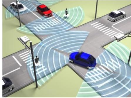
外部トリガー入出力信号を接続することで、複数のmiRadar®を同期して動作させることが出来ます。miRadar® 1は外部トリガー信号入力がないので、マスターモードに設定します。miRadar® 2, 3, 4はスレーブモードに設定し、外部トリガー信号入力により、同期して動作を行います。トリガー信号ケーブルは、弊社にご用命ください。
